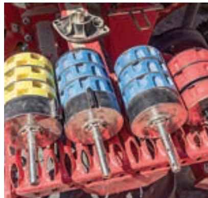
Ορισμένα από τα τμήματα στους ρότορες μέτρησης δεν ήταν σωστά στερεωμένα.
