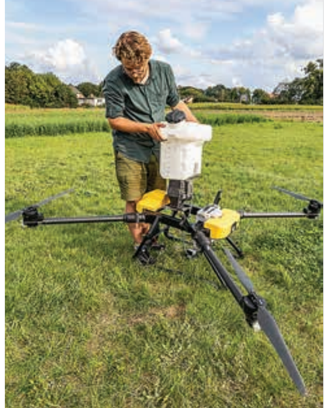
Η μονάδα διασποράς αφαιρείται και τοποθετείται εύκολα.
