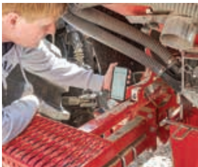
Η δοκιμή βαθμονόμησης πραγματοποιείται με μια εφαρμογή για smartphone.
