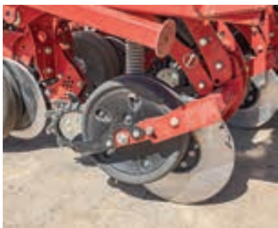
Δύο ελατήρια ασκούν πίεση στα μαχαίρια λιπασμάτων. Το βάθος ρυθμίζεται χειροκίνητα.
