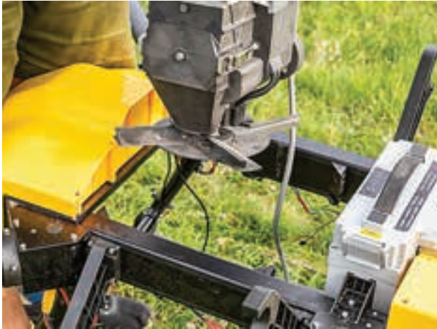
Ο ηλεκτρικός διανομέας με τέσσερα πτερύγια διασποράς προέρχεται από τη Lehner.
